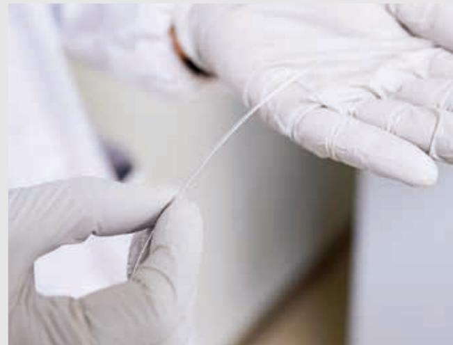
Fig.3——室温で押出成形された圧力可塑性高分子繊維
