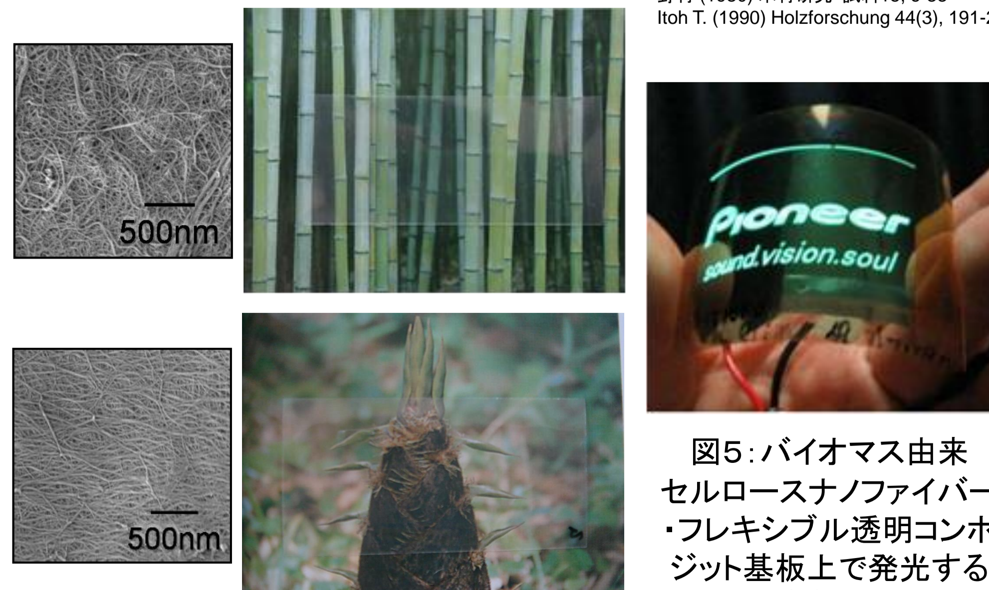
図4: タケノコ(下)・竹材(上)から製造したナノファイバーと透明ナノコンポジット: 脱リグニン処理無(上)は有(下)より処理によるダメージが少ない
